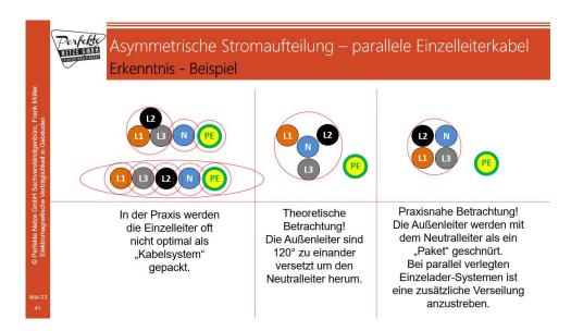
Die Verlegung der Einzelleiter muss zwingend als gebündeltes Kabelsystem erfolgen!
